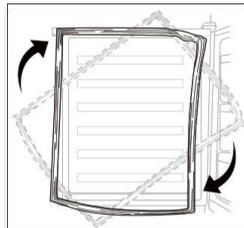
10. Tournez la charnière centrale à 180° et déplacez-la à gauche de l'appareil. Mettez l'axe de pivot de la charnière centrale dans le trou supérieur de la porte inférieure et serrez les vis.
