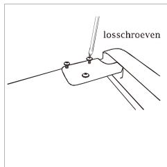
3. Verwijder de scharnierpen met een schroevendraaier en draai het scharnier om. Monteer de scharnierpen weer op de scharnierbeugel.
