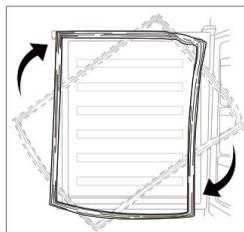
10. Draai het middelste scharnier 180 graden en verplaats het naar de linkerkant van het apparaat. Plaats de middelste scharnierpen in het gaatje bovenin de onderste deur en draai de schroeven aan.
