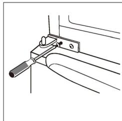
11. Fixez la porte supérieure à l'appareil. Veillez à ce que la porte soit bien alignée verticalement et horizontalement pour que le joint de fermeture corresponde bien de tous les côtés avant de serrer définitivement les vis de la charnière supérieure. Serrez bien les vis de la charnière supérieure en haut de l'appareil.
