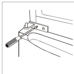
11. Plaats de bovenste deur weer op het apparaat. Zorg ervoor dat de deur horizontaal en verticaal is uitgelijnd, zodat de afsluitstrips aan alle kanten goed aansluiten op de deur voordat u het bovenste scharnier definitief bevestigt. Bevestig vervolgens het bovenste scharnier en schroef het vast aan de bovenkant van het apparaat.
