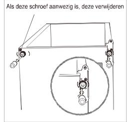
7. Schroef het onderste scharnier los en verwijder het, draai de beugel om en plaats het op de tegenoverliggende zijde.
