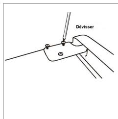
3. Retirez l'axe de pivot de la charnière avec un tournevis et retournez la charnière. Replacez l'axe de pivot sur le support de la charnière.
