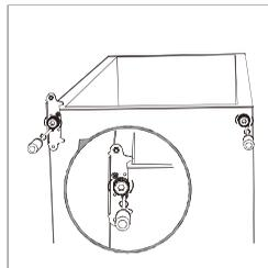
9. Trek de afdichtingsrubbers van de deur(en) los, draai 180° en druk deze weer terug op zijn plaats.
