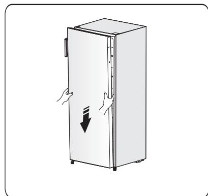
10. Bewegen Sie das obere Scharnierteil und stellen Sie die obere Scharnierachse in das obere Loch der Tür ein und stellen Sie die Position der Tür ein (Bitte tragen Sie die obere Tür mit der Hand, wenn Sie es tun) und befestigen Sie das obere Scharnierteil mit den speziellen Flanschschneidschrauben.
