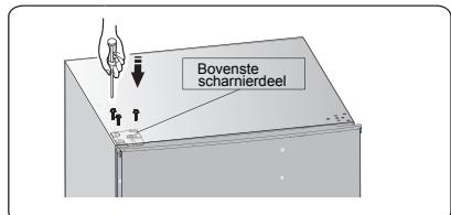
11. Installeer het deksel van het Schroefgat in de rechterbovenhoek van de koelkast. Installeer de bovenste scharnierdeksel (die zich in de plastic zak bevindt) in de linkerhoek. Plaats de andere bovenste scharnierdeksel in de plastic zak.
