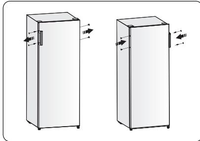
13. Öffnen Sie die obere Tür und installieren Sie die Türräger und dann schließen Sie sie.
