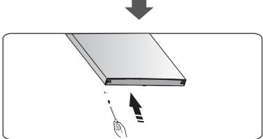
7. Leg de koelkast op een verpakking van zacht schuim of vergelijkbaar materiaal. Verwijder de beide verstelbare onderste voetgedeelte en het onderste scharniergeudeel door de speciale flens zelf-tappende schroeven los te draaien.
