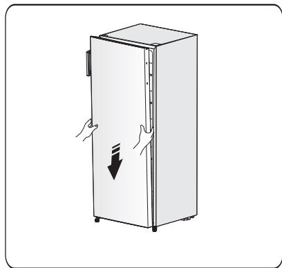
10. Plaats het bovenste scharniergeudeel en doe de bovenste scharnieres in het bovenste gat van de deur en pas de positie van de deur aan (ondersteun de deur met uw hand wanneer u dit doet), bevestig het bovenste scharniergeudeel met de speciale flens zelf-tappende schroeven.
