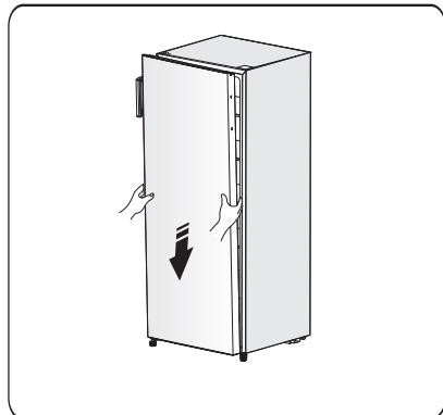
10. Transférez la partie supérieure de la charnière et faites rentrer l'axe de la charnière supérieure dans le trou supérieur de la porte, et ajustez la position de la porte (veuillez soutenir la porte avec la main), en fixant la partie supérieure de la charnière avec les vis autotaraudeuses spéciales à bride.
