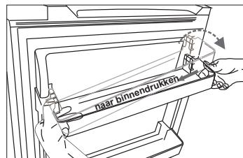
Teneerste tilt u de linkerzijde van het deurschap naar boven, en zorgt ervoor dat de inkeping aan de deur is bevestigd. Vervolgens drukt u de rechterzijde naar binnen, druk het naar beneden naar de rechterkant.
