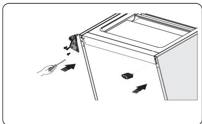
9. Bewegen Sie die Tür in die richtige Position, stellen Sie das untere Scharnierteil ein, und stellen Sie die Scharnierachse in das untere Loch der Tür.
