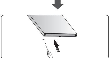
7. Posez le réfrigérateur sur un emballage en mousse souple ou un matériau similaire. Retirez les deux parties inférieures des pieds réglables et la partie inférieure de la charnière en dévissant les vis autotaraudeuses de la bride spéciale.
