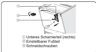
8. Ersetzen Sie das untere Scharnierteil auf die linke Seite und befestigen Sie es mit den speziellen Flanschschneidschrauben. Ersetzen Sie die vordere Fuß-Festplatte auf eine andere Seite und befestigen Sie sie.
