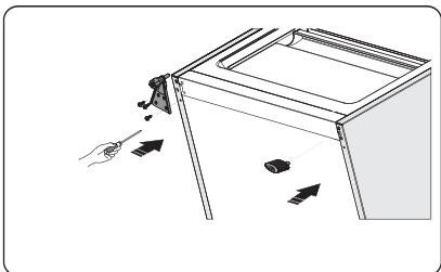
9. Transférez la porte sur la position de la propriété, ajustez la partie inférieure de la charnière, faites rentrer l'axe de charnière dans le trou inférieur de la porte.
