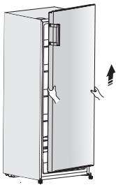
6. Placez-là sur une surface lisse avec son panneau vers le haut. Desserrez la vis ② et la pièce ①, puis installez-les sur le côté gauche et serrez-les fermement.
