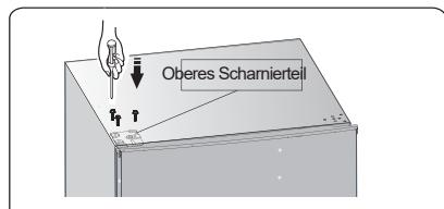
11. Installieren Sie die Schraubenlochabdeckung auf der oberen rechten Ecke des Kühlzentrums. Montieren Sie die obere Scharnierabdeckung (in der Plastiktüte) auf der linken Ecke. Setzen Sie die andere obere Scharnierabdeckung in die Plastiktüte.
