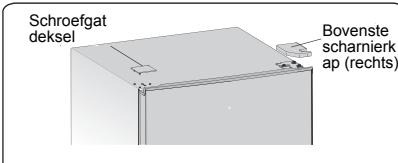
3. De speciale flens zelftappende schroeven losdraaien die worden gebruikt voor het bevestigen van het rechter bovenste scharnierdeel met een 8mm schroevendraaier of een moersleutel (Ondersteun aub. de bovenste deur met uw hand terwijl u deze handeling uitvoert).
