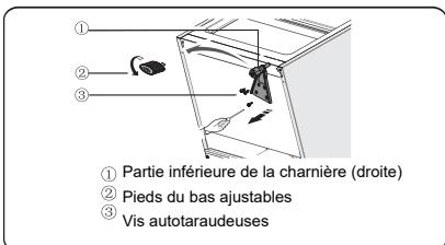
8. Remplacez la partie inférieure de la charnière sur le côté gauche et la fixez à l'aide des vis autotaraudeuses spéciales de la bride. Remplacer les parties inférieures des pieds réglables d'un autre côté et les fixer.
