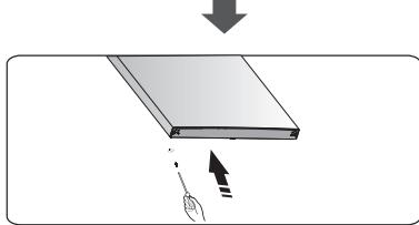
7. Legen Sie den Kühlschrank auf weiche Schaumverpackung oder ähnliches Material. Entfernen Sie beide einstellbaren Bodenfüße und das untere Scharnierteil, indem Sie die speziellen Flanschschneidschrauben abschrauben.
