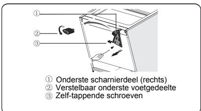
8. Plaats het onderste scharniergeudeel terug aan de linkerkant en bevestig deze met de speciale flens zelf-tappende schroeven. Vervang de verstelbare onderste voetgedeelten aan de andere kant en bevestig deze.
