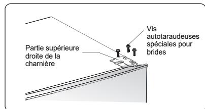
4. Retirez l'axe supérieur de la charnière, transférez-le sur le côté renversé et serrez-le fermement, puis placez-le dans un endroit sûr.
