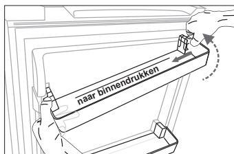
Druk de rechterzijde van het deurschap naar binnen, terwijl u de linkerkant vasthouwt. Wanneer de inkeping van de plank is losgemaakt vanuit de koelkastdeur, verwijdert u het rek schuin naar boven.
