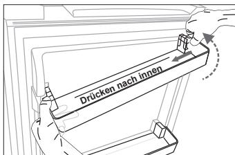
Drücken Sie die rechte Seite des Türfachs nach innen, während Sie die linke Seite halten. Wenn die Kerbe des Fachs von der Kühlchranktür losgelöst wurde, entfernen Sie das Fach schräg aufwärts.
