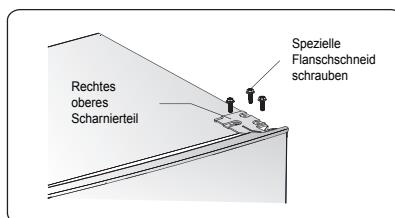
4. Entfernen Sie die obere Scharnierachse, bewegen Sie sie auf die umgekehrte Seite und ziehen Sie sie fest an, und legen Sie sie dann an einen sicheren Ort.
