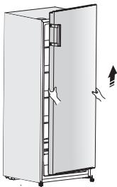
6. Legen Sie die obere Tür auf eine glatte Oberfläche mit seiner Verkleidung nach oben. Lösen Sie die Schraube ② und das Teil ①, und installieren Sie sie dann auf die linke Seite und sie fest anziehen.
