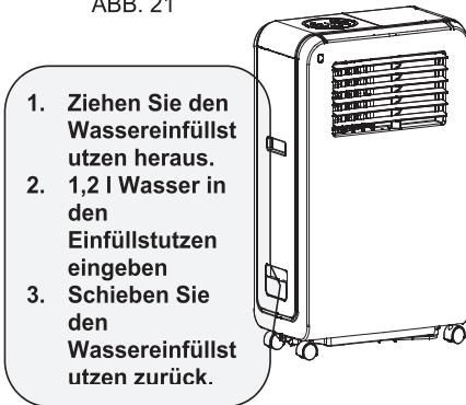
1. Ziehen Sie den Wassereinfüllstutzen heraus.
